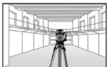
Referencia para la instalación de ventanas
