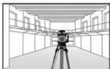
Repère pour l'installation d'une fenêtre
